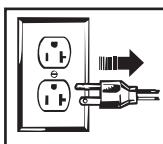
**DESACTIVE, DESCONECTE Y BLOQUEE TODAS LAS FUENTES DE ENERGÍA DURANTE EL MANTENIMIENTO.**
